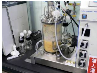
こちらは、M2の奥平さんが出光興産アグリバイオ事業部と共同研究を行っている「MEL」を製造しているところです。 MELとは、微生物が産生する界面活性剤の一種で、抗生物質代替物としての可能性を探っています。
