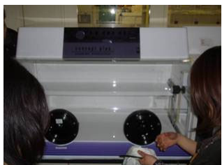
こちらの機械は嫌気チャンバーなるもの。酸素に弱いルーメン内の嫌気性細菌を扱う実験では重要な機械の一つです。
