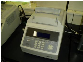
これはサーマルサイクラーという機械で、 PCR(Polymerase Chain Reaction)により DNAを増幅する装置です。 栄養も2台所有していますが、こちらのほうが若干(?) コンパクトで省スペースタイプです。
