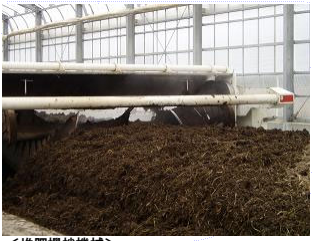
<堆肥攪拌機> 未熟堆肥を自動運転で攪拌し、堆肥化を促進します。
